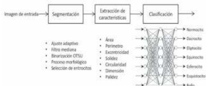
Figura 3. Diagrama del proceso automático de clasificación.
