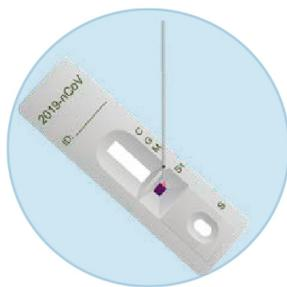
Agregar 2 $\mu$ L de muestra de sangre en área "S1" según se observa en la figura.
